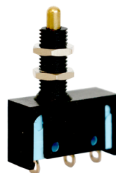
Poussoir télescopique avec surcourse CRA = 3 mm et canon fileté M6 x 0,75
