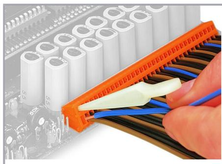
Les outils de manipulation offerts ci-dessus conviennent pour le câblage côté usine de barrettes à bornes et offrent, par rapport aux tournevis, une opération encore plus confortable.
