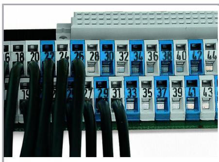
Les barrettes à bornes agencées les unes derrière les autres permettent une économie de place – pour un agencement en décalage d'un demi pas, elles facilitent le câblage ultérieur de la rangée avant.
