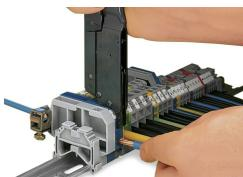
Pour desserrer le cran de verrouillage de la pince, serrer les poignées au delà du cran. Enlever ensuite la pince de la borne pour la placer sur la borne suivante.
