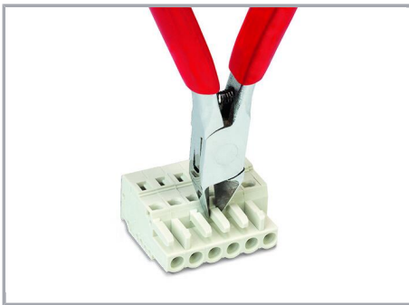
Détrompage d'un connecteur femelle – couper la(les) tige(s) de codage.
