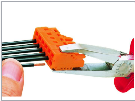
Connexion de conducteur à l'aide d'outil de manipulation
