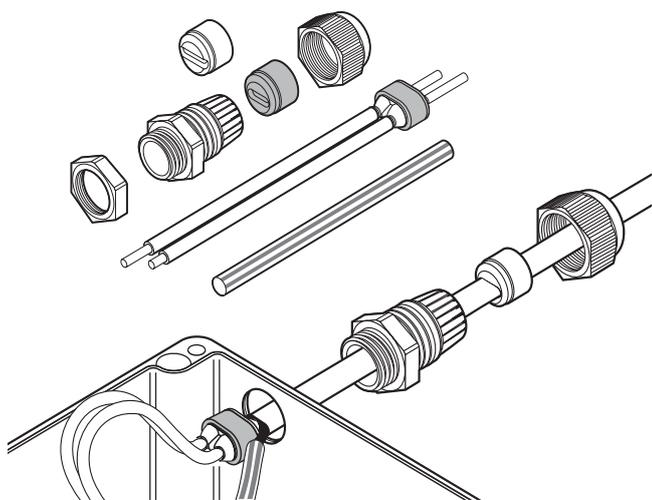
Ce kit de raccordement assure la liaison des rubans chauffants à circuit parallèle de type nVent RAYCHEM BTV, QTVR, XTV, KTV, HTV et VPL industriels à la boîte de raccordement tout en maintenant l'isolation électrique des conducteurs et de l'âme du ruban chauffant. Il est agréé pour un usage en zones explosives.
