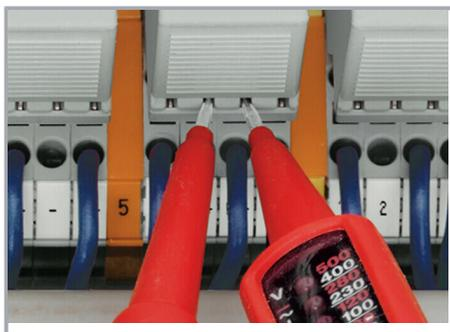
Tester le fonctionnement par simple contact protégé
