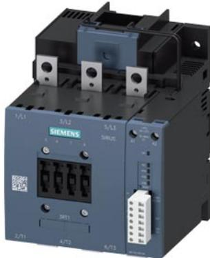
contacteur de puissance, AC-3 115 A, 55kW / 400V AC (50-60 Hz) / commande par courant continu 96-127 V AC / DC contacts auxiliaires 1 NO + 1 NF 3 pôles, taille S6 raccordement par barres entraînement : électronique avec API / interface SIMOCODE et indication de la durée de vie résiduelle
