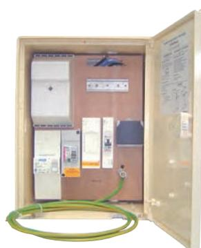
Le coffret P 490 existe équipé en plus d'une prise 16 A (2 P + T) protégée par un disjoncteur 16 A et de 3 m de câble 25 mm<sup>2</sup> H07V-K vert-jaune pour la mise à la terre.
