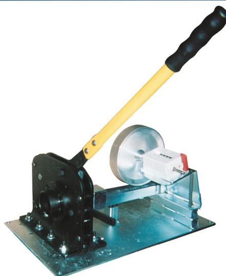
Par principe la mesure par défilement d'un produit long ne peut pas être d'une précision parfaite. Il incombe à l'utilisateur de réaliser ses propres essais pour déterminer le pourcentage de précision pour les différents produits à mesurer.
