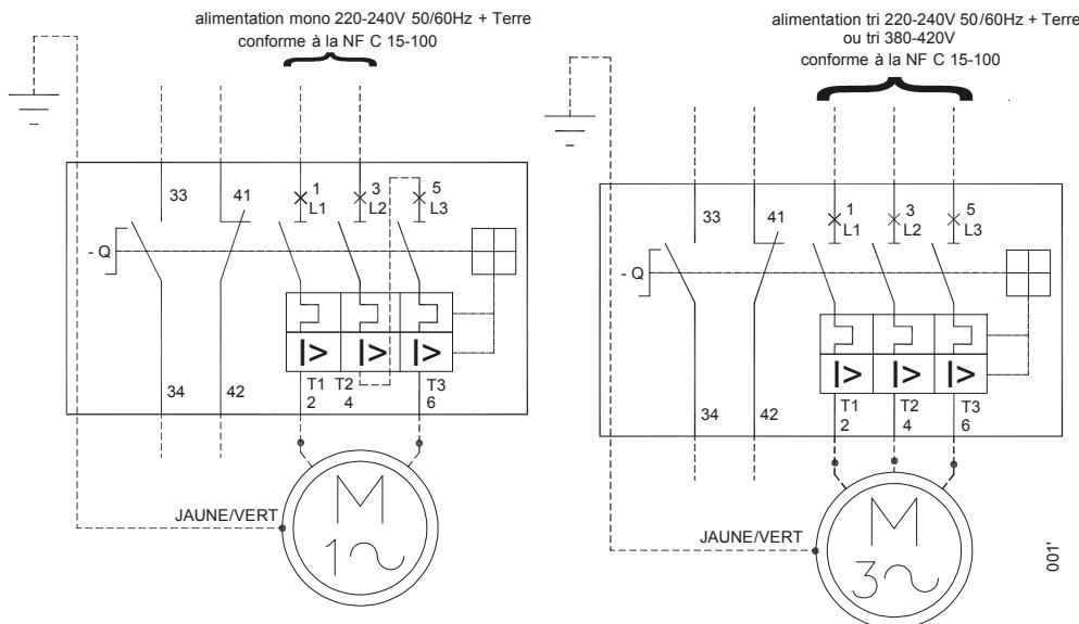
\_\_\_\_\_ Câblage interne à l'appareillage
