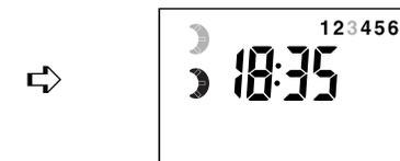
Beim nächsten Programmwechsel wird die Übersteuerung aufgehoben.
