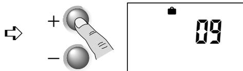
3 Sekunden nach dem Tastendruck wird die Anzahl der Abwesenheitstage gespeichert.
