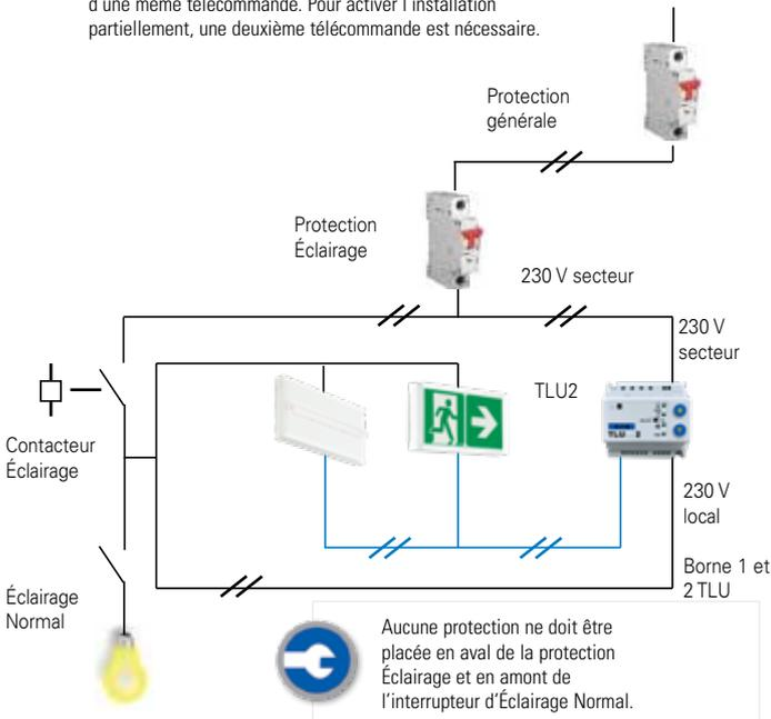
Aucune protection ne doit être placée en aval de la protection Éclairage et en amont de l'interrupteur d'Éclairage Normal.
