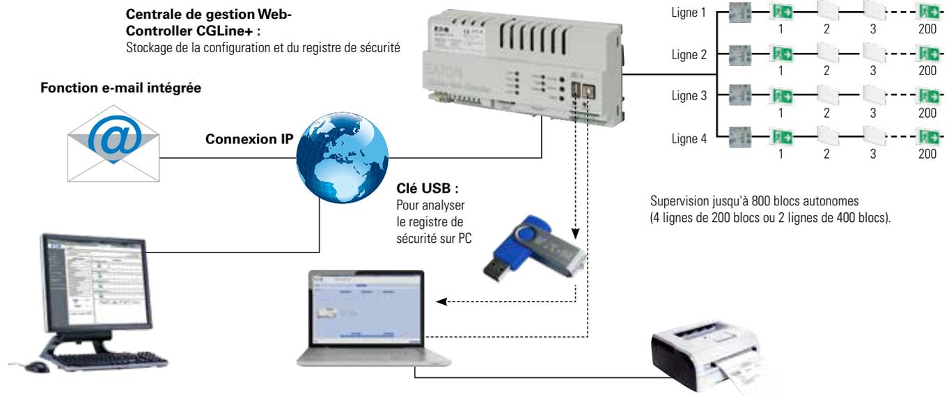
**Accès au Web Serveur** par un PC connecté au réseau ou par une connexion sans fil locale (uniquement avec les centrales équipées de cette option)
