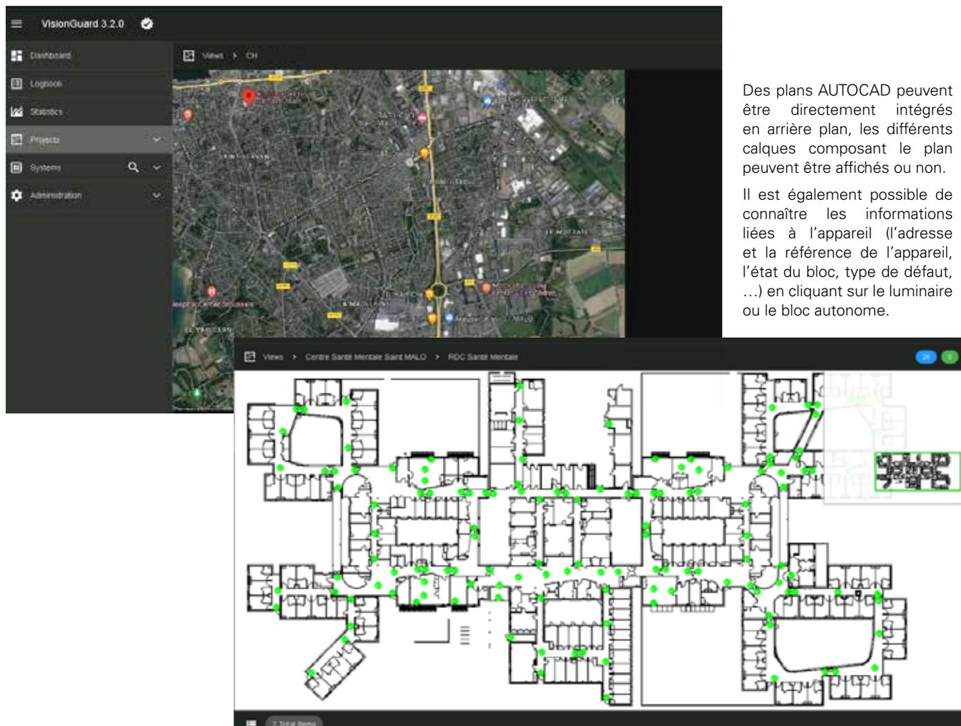
Des plans AUTOCAD peuvent être directement intégrés en arrière plan, les différents calques composant le plan peuvent être affichés ou non.
