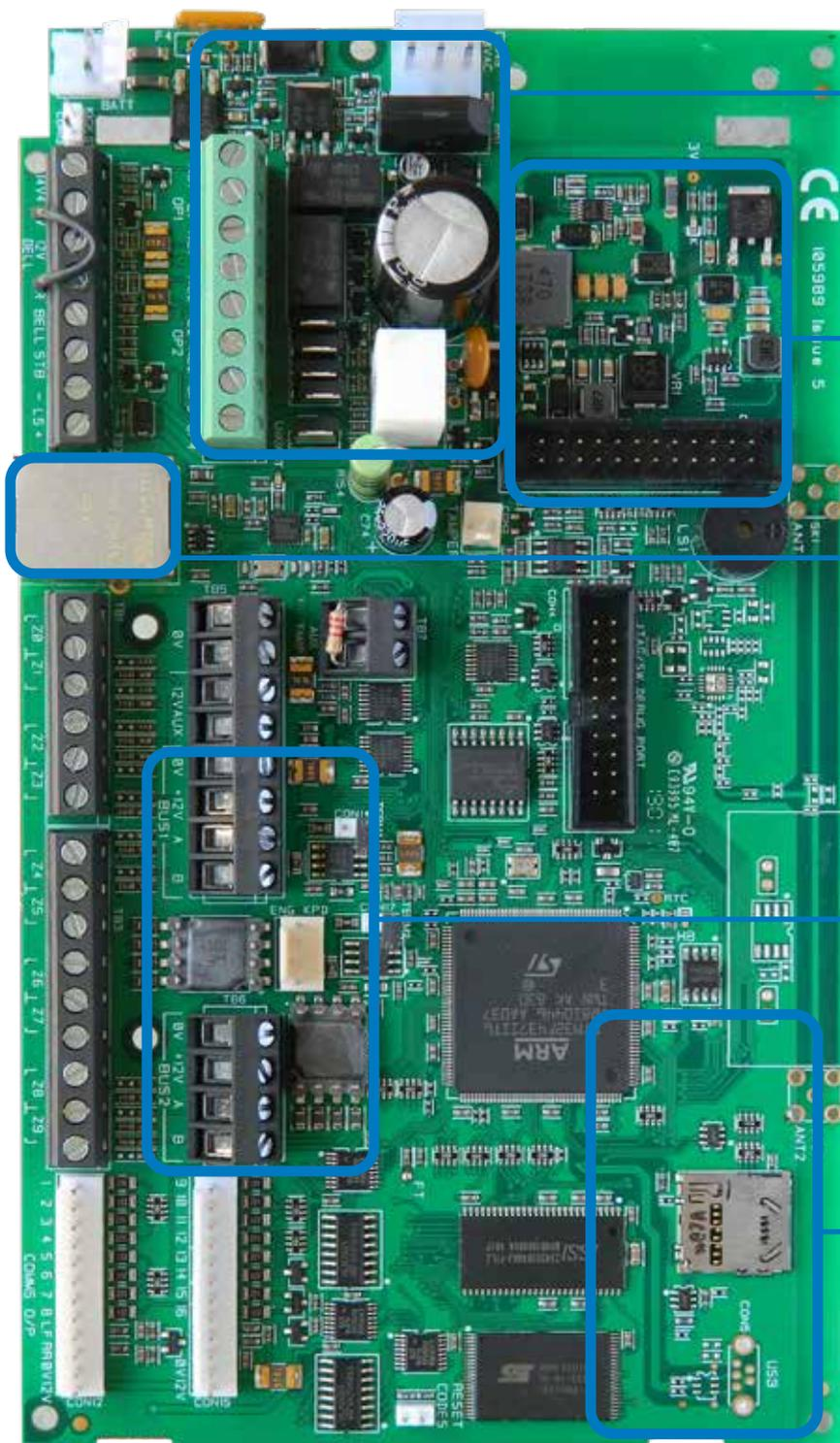
Alimentation Chargeur 2A Protégée par Fusibles à Réarmement Automatique
