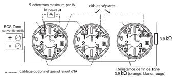
Raccordement des socles équipés d'indicateurs d'action
