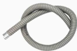
La gamme **CAPRIPLAST** de Capri se compose de conduits en acier zingué et acier inoxydable 304L revêtus d'une gaine PVC grise. Dotés d'une très forte résistance à l'écrasement et à la traction, les conduits **CAPRIPLAST** sont particulièrement adaptés aux environnements industriels sévères avec de fortes sollicitations mécaniques.
