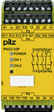
Bloc logique de sécurité (autonome), entrées : câblage monocanal / à deux canaux avec / sans détection des courts-circuits, sorties : 3 F, 1 O, 1 sorti statique, réarmement automatique / manuel, UB 24 - 240V AC/DC, largeur : 45 mm, borniers à vis débrochables, surveillance des arrêts d'urgence, des protecteurs mobiles.
