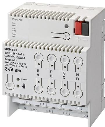
L'actionneur de commutation N 567/11 est un appareillage de type N pour montage sur rail DIN. Grâce à ses 8 sorties relais (canaux), il peut commuter 8 groupes de consommateurs électriques indépendamment les uns des autres. Le raccordement au bus peut être réalisé soit par le bornier bus ou par contact sur un rail de donnée installé dans le rail-DIN.
