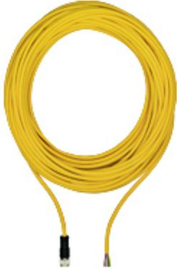
Câble de raccordement, PUR, jaune RAL1003, blindé, connecteur femelle droit M12 à 8 broches, libre de câblage, codé A, longueur du câble : 10m
