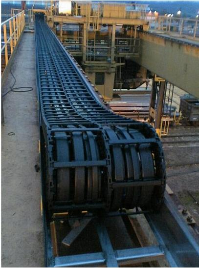
Il est conseillé d'utiliser une chaîne 3 bandes afin d'isoler les différents types d'énergie au sein d'une même chaîne porte-câbles et de permettre le transport de charges lourdes sur de très longues courses.
