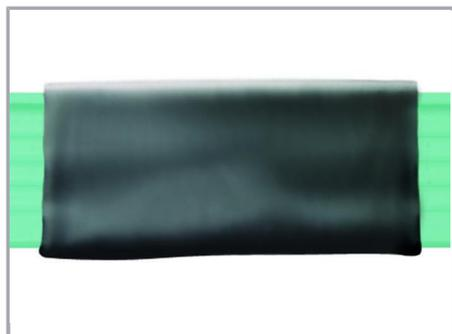
Après la suppression d'un module, il faut réparer le câble plat avec du ruban isolant.
