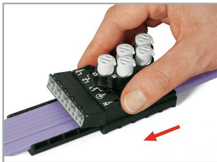
Monter le module IDC (raccordement par perçage d'isolant) à fleur sur la pièce inférieure.
