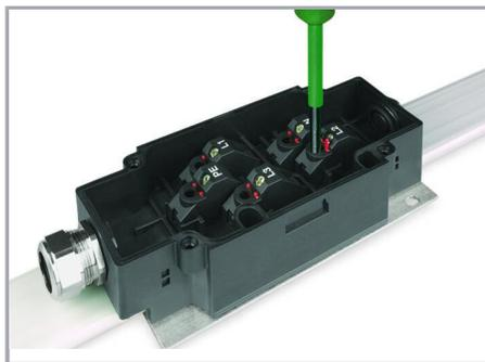
Les languettes rouges (lorsqu'elles sont à fleur de la paroi du bloc) servent au contrôle du câblage.
