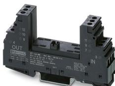
Embase pour fiche de protection PT avec circuit de protection pour un circuit de signal bifilaire sans potentiel de terre. Montage sur NS 35/7,5 et NS 35/15, largeur de boîtier : 17,5 mm.
