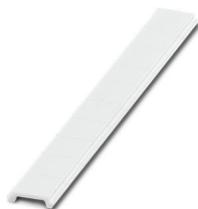
Ruban de repérage ZB, plat, Rubans, blanc, vierge, repérable avec : CMS-P1-PLOTTER, PLOTMARK, type de montage: encliquetage, pour bloc de jonction au pas de : 5 mm, surface utile: 5,15 x 5,15 mm, Nombre d'étiquettes: 1000
