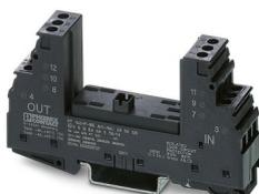
Embase pour fiche de protection PT avec circuit de protection pour un circuit de signal bifilaire sans potentiel de terre. Eclateur à gaz intégré servant de protection primaire entre GND et PE. Montage sur NS 35/7,5 et NS 35/15, largeur de boîtier : 17,5 mm.
