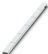
Ruban de repérage ZB, à commander : par bandes, blanc, impression selon les indications du client, type de montage: encliquetage dans la rainure de repérage élevée, pour bloc de jonction au pas de : 18 mm, surface utile: 18 x 5 mm, Nombre d'étiquettes: 5
