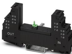
Embase pour fiche de protection PT avec circuit de protection pour circuits de signaux bifilaires sans potentiel de terre, éclateur à gaz entre les connexion 3-4 (GND) et 9-10, montage sur NS 35/7,5 et NS 35/15, largeur de boîtier : 17,5 mm
