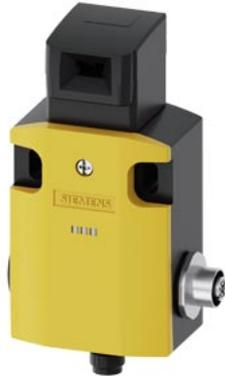
Interrupteur de position de sécurité à détrompeur séparé 5 sens d'accostage Boîtier métallique, 56 mm de large ASIsafe intégré État AS-i: 1:F-IN1, 2:F-IN2 3:AS-i/FAULT Contacts à action dépendante 1 NF avec connecteur M12, 4 pôles Voie 1 sur NF, voie 2 sur connecteur femelle M12 à droite
