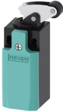
Interrupteur de position boîtier en matière plastique selon EN 50047, 31 mm Raccordement d'appareil 1 x (M20 x 1,5) Contacts à action dépendante 1 NO / 1 NO Levier à galet d'équerre avec galet plastique, 13 mm
