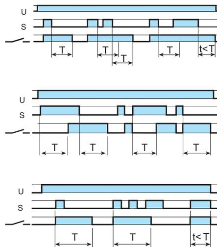
**(BE) Temporisé à la coupure avec signal de commande**
