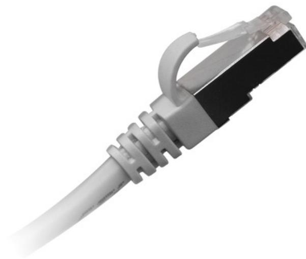
Les **cordons de brassage GIGAMEDIA CAT6 S/FTP** sont équipés de connecteurs de type modular plug avec dorure 50  $\mu$ . Ils disposent d'un manchon injecté de type "snagless" qui évite les accrochages et facilite l'installation et la manipulation des cordons dans les armoires de brassage.
