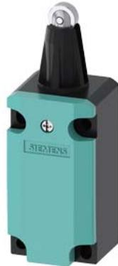
Interrupteur de position Boîtier métallique, 40 mm selon EN 50041, Raccordement d'appareil 1 x (M20 x 1,5) contacts à action brusque 1 NO / 2 NF, Poussoir à galet, avec dépassement de course de 3 mm et galet en acier inoxydable 13 mm
