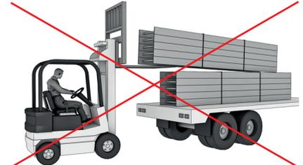
Image 2 Déchargement avec chariot élévateur
