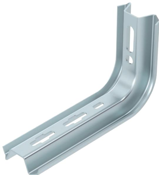
Console pour le montage sur pendants TPS ou comme console murale dans le cadre d'une pose standard du chemin de câbles pour la sécurité de fonctionnement selon DIN 4102 partie 12.
