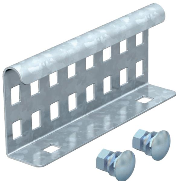
Eclisse droite extérieure, pour le raccordement des échelles à câbles et des pièces de forme d'une hauteur d'aile de 60 mm et une perforation traversante du longeron.
