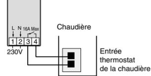
Si nécessaire, supprimez le shunt (fil électrique) reliant les deux bornes de l'entrée thermostat.
