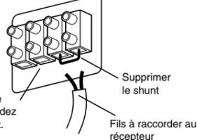
Si la chaudière possède une entrée horloge, ne la confondez pas avec l'entrée thermostat.
