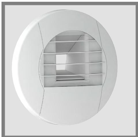
Les bouches d'extraction hygroréglables ou temporisées BEH HYGRO, TEMPO ou DETECTION rentrent dans le cadre de l'Avis Technique des systèmes de ventilation hygroréglable BEH(n° 14.5/17-2284 et n° 14.5/17-2278). Ces systèmes permettent d'assurer une modulation des débits d'air extraits en fonction de l'humidité relative des pièces de service ainsi que la gestion temporelle des débits complémentaires d'extraction.
