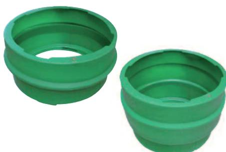
Rehausse découpable et ajustable, elle s'emboîte et se fixe par 1/4 tour. Le couvercle de la station de relevage **COLLECTIFOS PE** s'adapte sur la rehausse. La partie inférieure s'encastre dans la partie supérieure, facilitant ainsi le réglage en hauteur.
