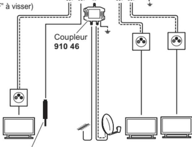
En cas de non utilisation d'une sortie, il est nécessaire d'utiliser le bouchon de charge fourni
