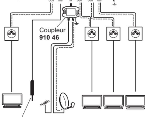
En cas de non utilisation d'une sortie, il est nécessaire d'utiliser le bouchon de charge fourni
