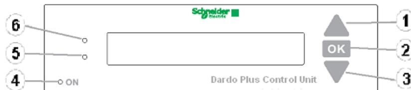
2. Faire défiler les commandes en utilisant les boutons n° 1 ou 3 (flèche haut ou flèche bas) jusqu'à ce que l'indication « Test de Fonctionnel » apparaisse sur la deuxième ligne de l'afficheur.
