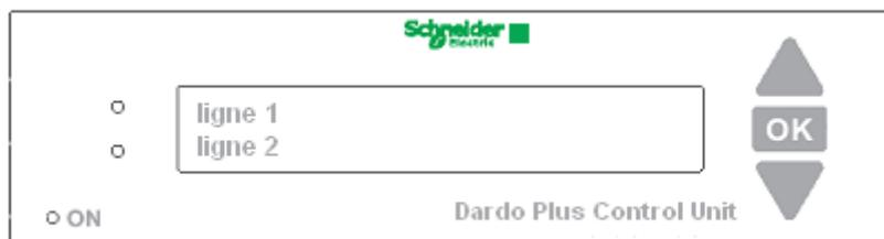
Pendant le fonctionnement normal, l'AFFICHEUR de l'unité de contrôle passe automatiquement à la visualisation de la ligne 1 qui présente dans l'ordre tous les menus de contrôle du système. Pour modifier l'affichage, utiliser les boutons HAUT, OK, BAS (voir page 24).
