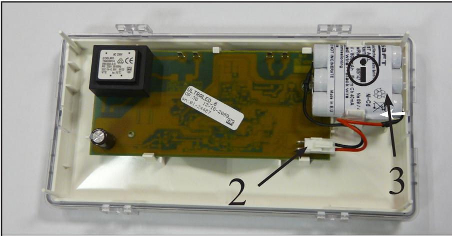
2 débrancher les accumulateurs / disconnect batteries
