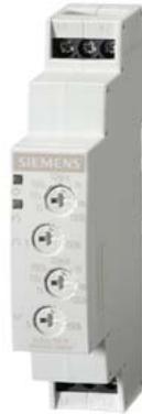
Relais temporisé, électronique Générateur d'horloge, 1 contact inverseur 7 plages de temporisation 0,05 s... 100 h CA/CC 12...240 V avec LED, borne à vis
