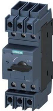
Disjoncteur de taille S00 pour la protection des installations avec mit Approbation circuit-breaker UL 489, CSA C22.2 NO.5-02 Déclencheur de surcharge à temps dépendant 4 A Déclencheur de court-circuit 52 A borne à vis pouvoir de coupure standard
