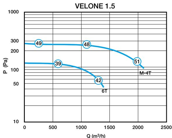
Caractéristiques aérauliques et acoustiques VELONE 1.5M 0.24 KW+IP
