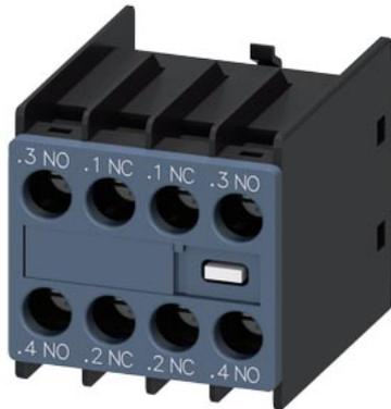
Interrupteur auxiliaire à l'avant, 2 NO + 2 NF Circuit 1 NO, 1 NF, 1 NF, 1 NO pour 3RH2 et 3RT2 borne à vis .3/4, .1/2, .1/2, .3/4
