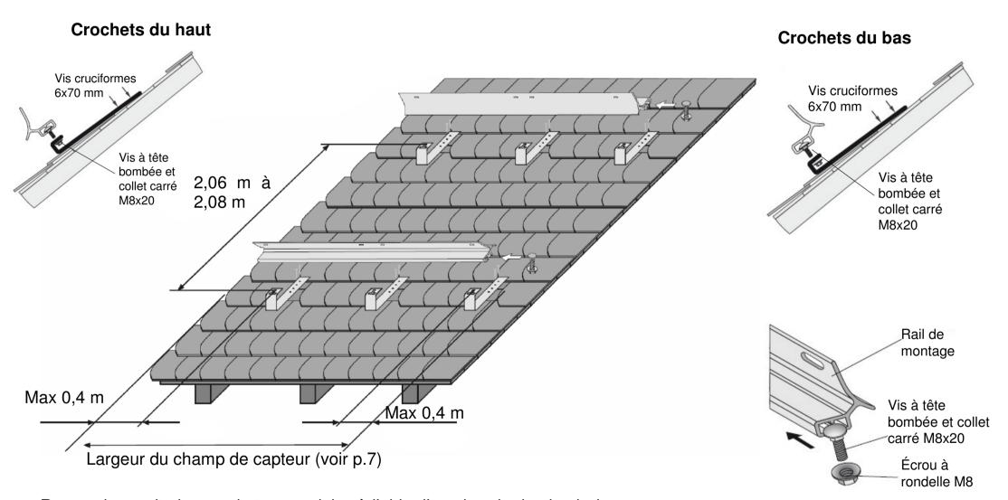
Recouvrir ensuite les crochets en ardoise à l'aide d'une bande de plomb du commerce. Couvrir le toit.
