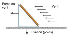
Des traverses en béton armé peuvent par exemple être placées sur le toit plat et les châssis peuvent être fixés à ces traverses. Le poids requis des traverses en béton armé est fonction de la force du vent qui augmente avec la hauteur du bâtiment. Si le poids des traverses entraîne un dépassement de la charge autorisée du toit, les capteurs sont bloqués par un poids minimal de 100 kg par capteur et fixés par des câbles métalliques pour empêcher leur chute.
