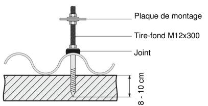
Tous les tire-fonds fournis doivent être uniformément disposés sur la largeur du champ de capteurs afin de répartir les charges.
