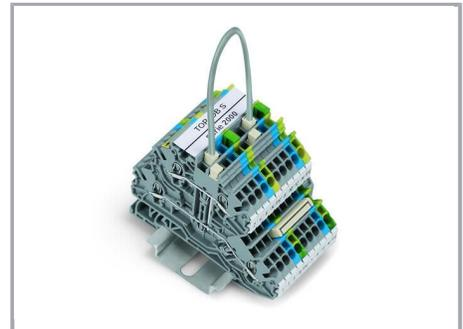
Pousser les conducteurs de pontage (2009-402) jusqu'en butée. Pour un changement du câblage, extraire le conducteur de pontage à l'aide de l'outil de manipulation au niveau de la rainure prévue au contact de pontage.
