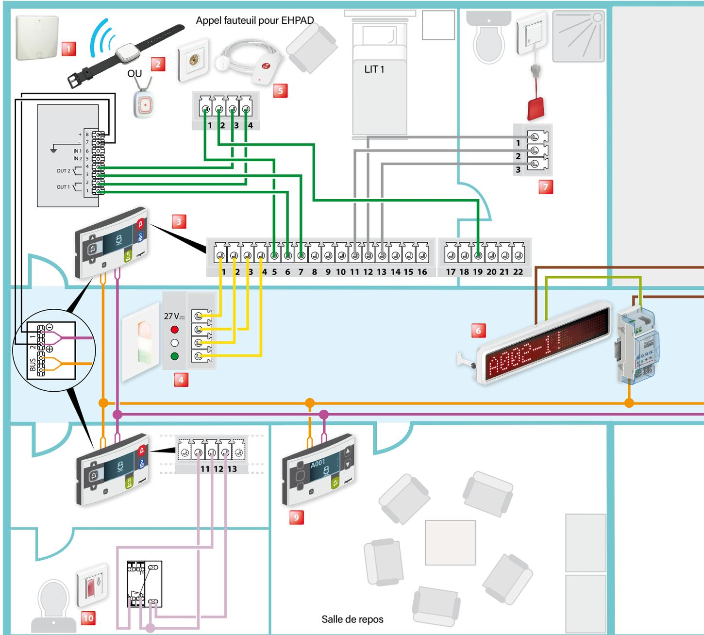
**1** Récepteur radio réf. 51IVXNE1011013-01 pour émetteurs radio portatifs
