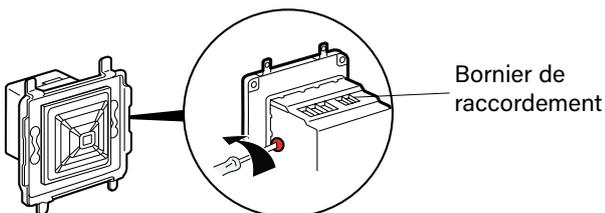
Réglage usine du gain très faible. Possibilité de réglage du gain/amplification du micro.
