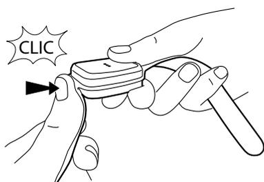
7 Vérifier que le bracelet est en place en tirant sur les extrémités : les ergots ne doivent pas ressortir.
