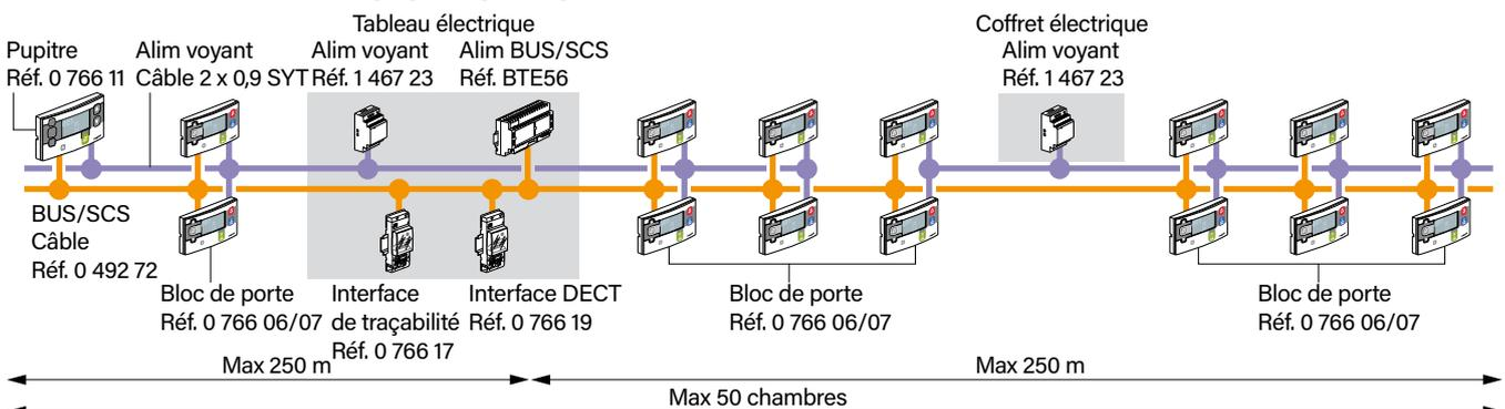
— Câble BUS/SCS réf. 0 492 72/75 — Câble alimentation voyant 2 x 0,9 SYT ou 2 x 1 mm<sup>2</sup> 1 paire AWG19 ou AWG18
