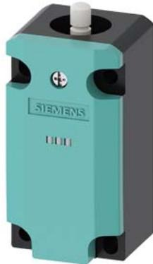
Interrupteur de base pour interrupteur de position 3SE51 boîtier plastique 40 mm selon EN 50041 Raccordement d'appareil 1 x (M20 x 1,5) avec 2 LED, jaune/verte, 24V CC Contacts à action dépendante 1 NO / 2 NF sans tête de commande
