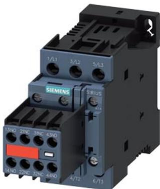
Contacteur de puissance, AC-3 17 A, 7,5 kW / 400 V 2 NO + 2 NF, 24V CC, avec varistance enfichée 3 pôles, taille S0 borne à vis Interrupteur auxiliaire non amovible
