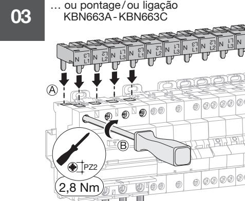
Bornes de raccordement/Bornes de ligação
