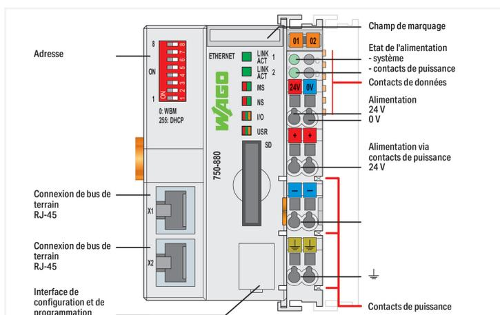
En combinaison avec le WAGO-I/O-SYSTEM, il est possible d'utiliser le contrôleur ETHERNET en tant qu'automate programmable dans des réseaux ETHERNET.
