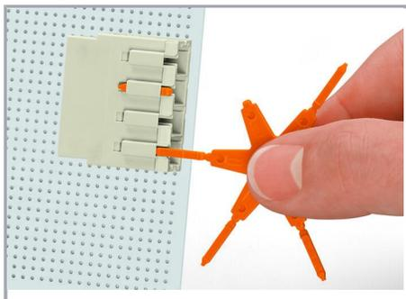
Codage d'un connecteur mâle THT en faisant glisser un détrompage.
